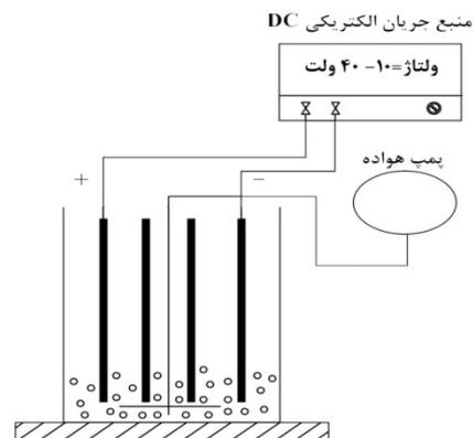
شکل ۱: نمایی از راکتور الکتروشیمیایی با الکترودهای دو قطبی
