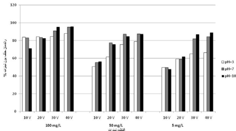
نمودار ۲: تأثیر ولتاژ بر روی راندمان حذف یون نیترات توسط فرایند الکتروشیمیایی هوادهی شده در سه محدوده  $pH (3, 7, 10)$  و در غلظت های  $(100, 50, 5)$  میلی گرم در لیتر (نیترات در زمان ۶۰ دقیقه)
