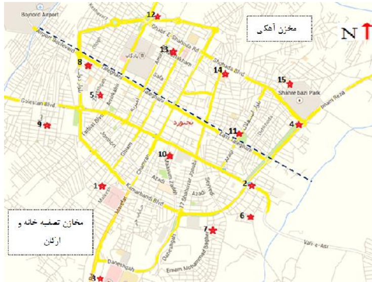
شکل ۱: کد نقاط نمونه برداری از شبکه توزیع آب بجنورد به تفکیک مناطق تحت پوشش مخازن آب
