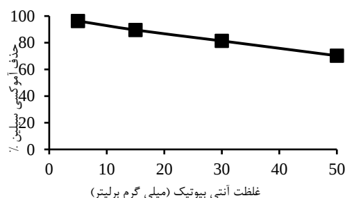
نمودار ۲. تغییرات کارایی حذف آموکسی سیلین نسبت به تغییرات غلظت اولیه آن در شرایط بهینه (غلظت پرسولفات = ۵ میلی مولار، زمان تماس = ۱۲۰ دقیقه و pH=6)
