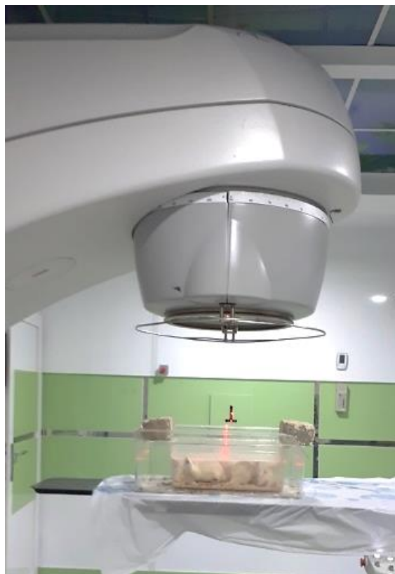
شکل ۱. پرتودهی به موش‌ها با استفاده از شتاب‌دهنده خطی Elekta-Compact با SSD = 100 سانتی‌متر و آهنگ دوز 3/5 گری بر دقیقه. کل موش‌های هر گروه (۶ سر) درون جعبه پلکسی‌گلاس که دارای سوراخ‌هایی برای تبادل هوا بود، قرار گرفتند.
