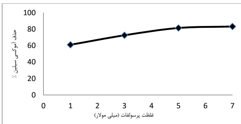
نمودار ۳. تأثیر غلظت اولیه پرسولفات در بازده حذف آموکسی سیلین (غلظت آموکسی سیلین = ۵ میلی گرم بر لیتر، pH بهینه = ۶ و زمان واکنش = ۱۲۰ دقیقه) در فرایند اشعه فرابنفش، امواج اولتراسونیک و پرسولفات
